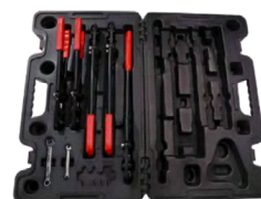
อุปกรณ์สำหรับติดตั้งข้อต่อแบบสวมอัด PEX press tool
