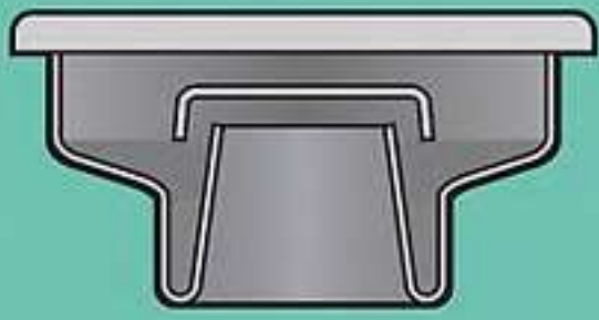
ตะแกรงกันกลิ่นทั่วไป จะเหลือ รูระบายน้ำเพียง 1.5 นิ้ว General floor drain has the diameter of internal drain tube 1.5 inches.
